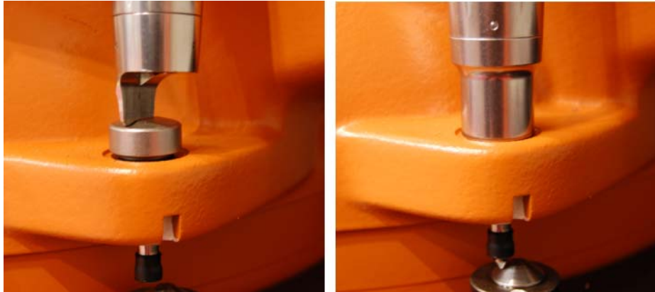
图 3-7: 已将 EMD 拧到测量筒上
